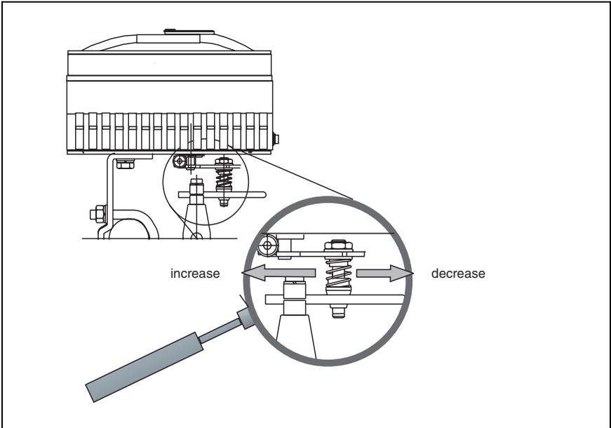
**Fig. 10 Positioner linkage**
