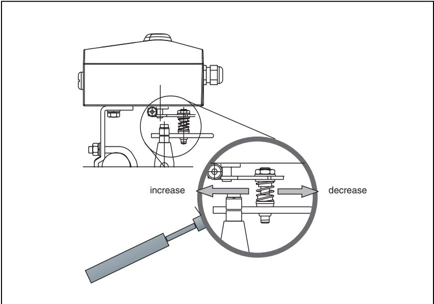
**Fig. 10 Positioner linkage**
