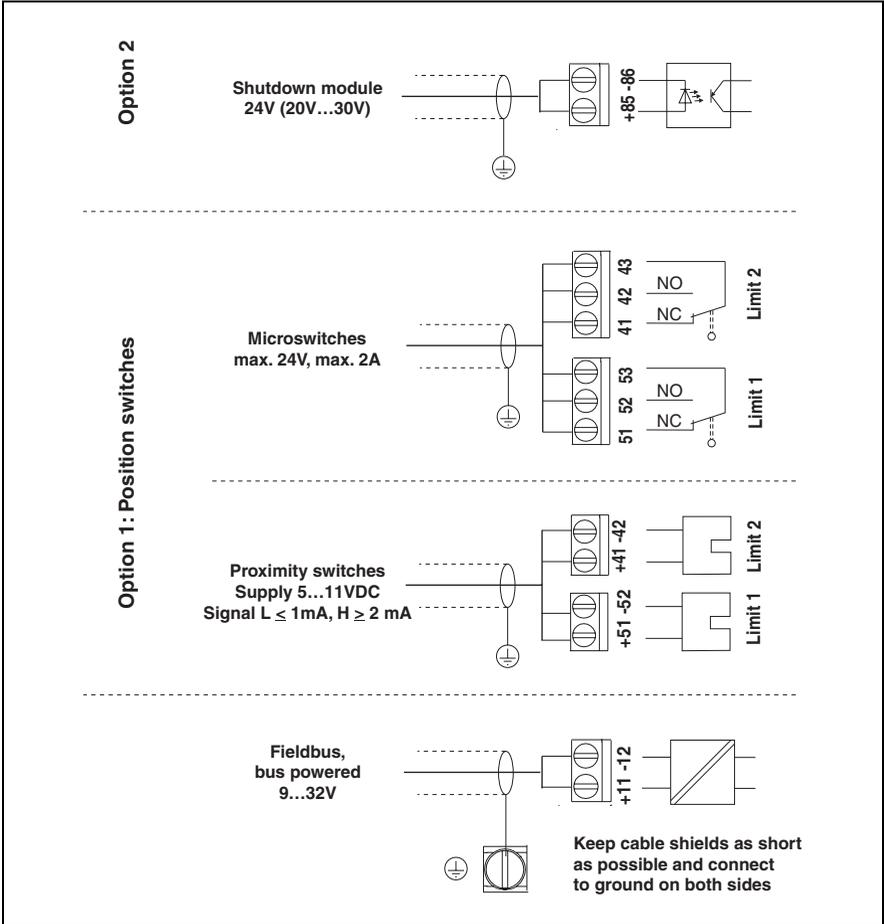
Fig. 19 Wiring diagram
